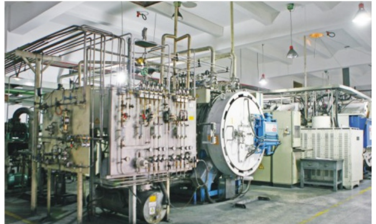
Sinter HIP boşlukları yok ederek tungsten karbürün mikro yapısını iyileştirir. Sinter HIP-can im the microstructure of the cemented carbide by eliminating the porosity.
