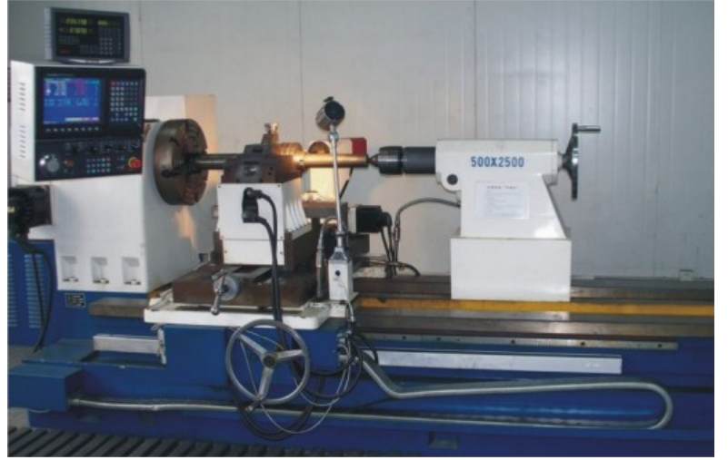
Ringlerin hassas işlenmesi için özel makinalar Special Machine for Processing High Precision Thread Roll - Rings
