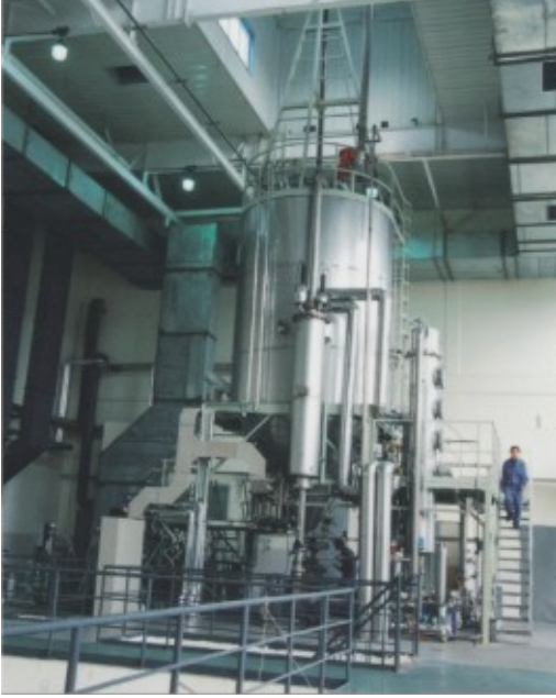
Yüksek kaliteli malzeme üretimi için sprey kurutucu Spray Dryer for Manufacturing High Quality Materials
