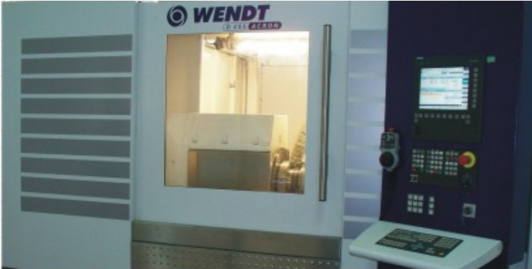
Yüksek hassasiyetli ringlerin işlenmesi için özel taşlama tezgahı Introduced Special Grinding Machine for Processing High Precision Roll - Rings
