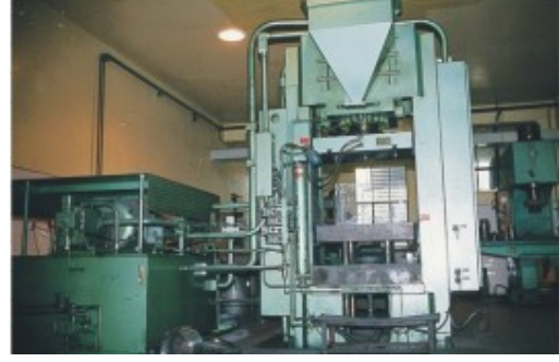
Ringlere hassas şekilde form verilmesi için Alpha pres ALPHA Pres for Precision Forming of Rolls - Rings
